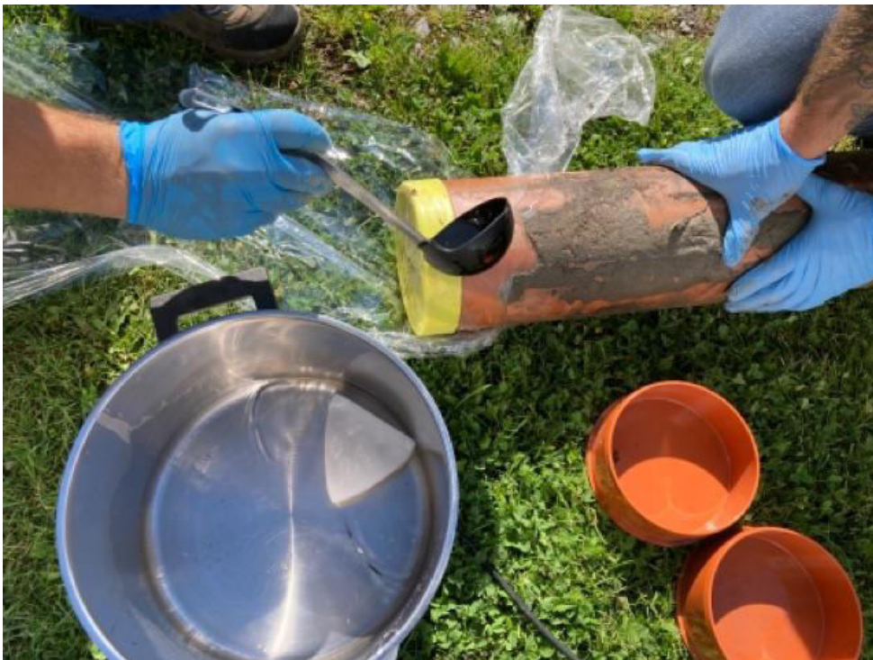
Abdichtungsmaßnahmen nach Probengewinnung
