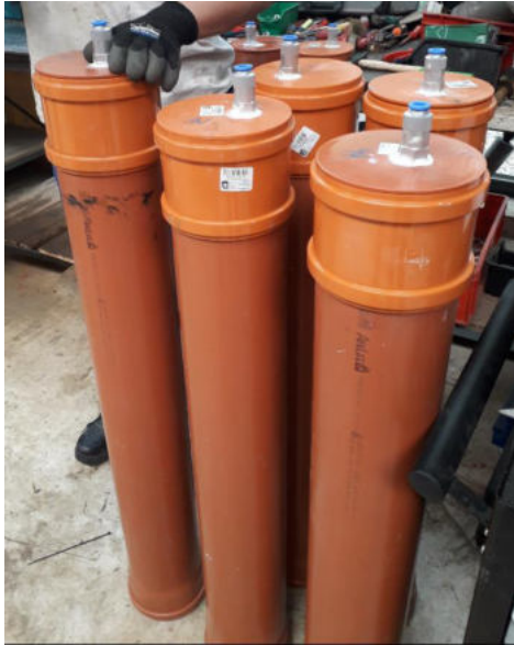
Abb 4: Kanalrohre mit Muffen und Ventil- „in“-Seite bereits vollständig abgedichtet (links) sowie (rechts)vorbereitete Abdeckungen Kanalrohr mit Ventilen und Abdichtungsmasse
