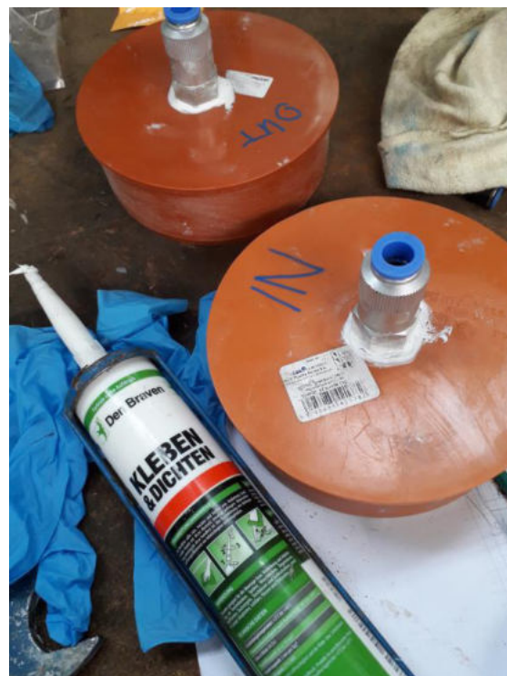
Vorbereitung von Rohren – eine Seite fertig verklebt und abgedichtet, 2. Seite bleibt für die Arbeit im Feld offen
