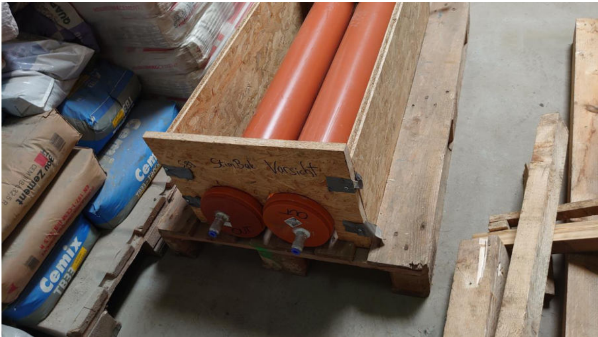
Transportfixierung, um Ventile nicht zu beschädigen
