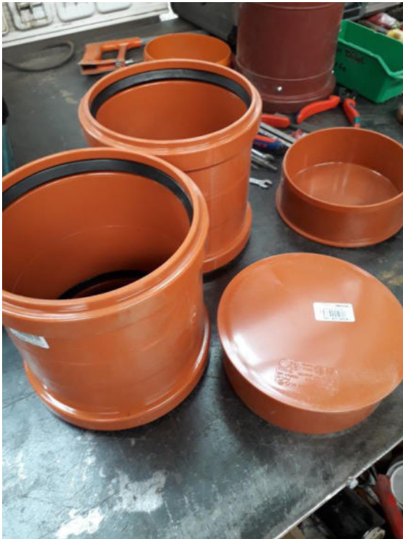
Bauteile für Inliner-Verpackung; Vorbereitung in der Werkstatt- Abdichtung der Ventile in den Deckeln
