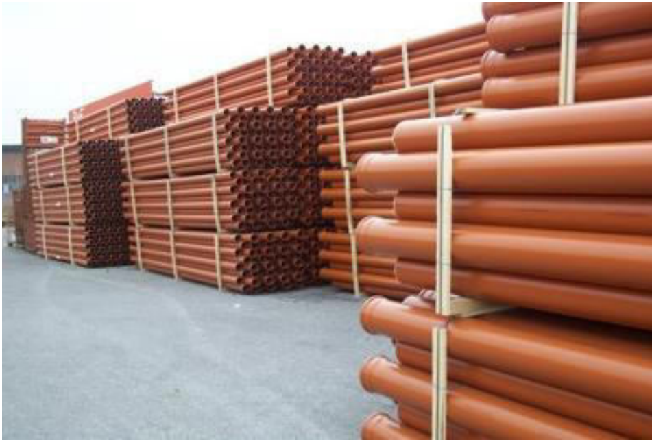
Hülle für Inliner: klassisches Kanalrohr
