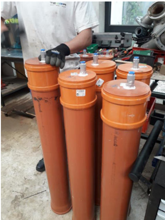
Vorbereitung von Rohren – eine Seite fertig verklebt und abgedichtet, 2. Seite bleibt für die Arbeit im Feld offen
