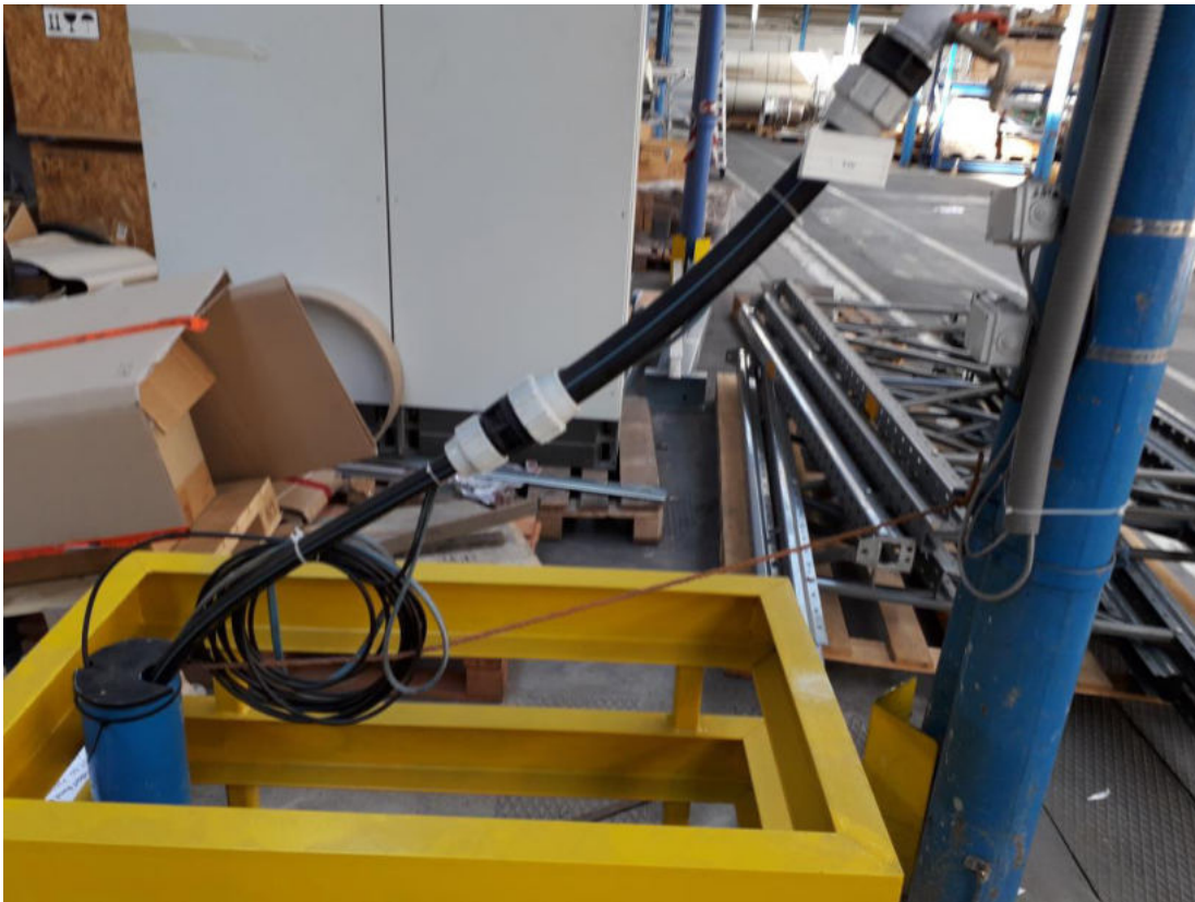
Sicherungspegel in der Halle inkl. Probenahmeahn
