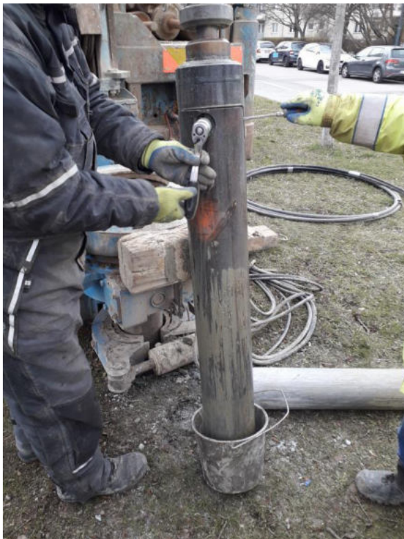
Öffnen der Halterung und Entnahme Liner
