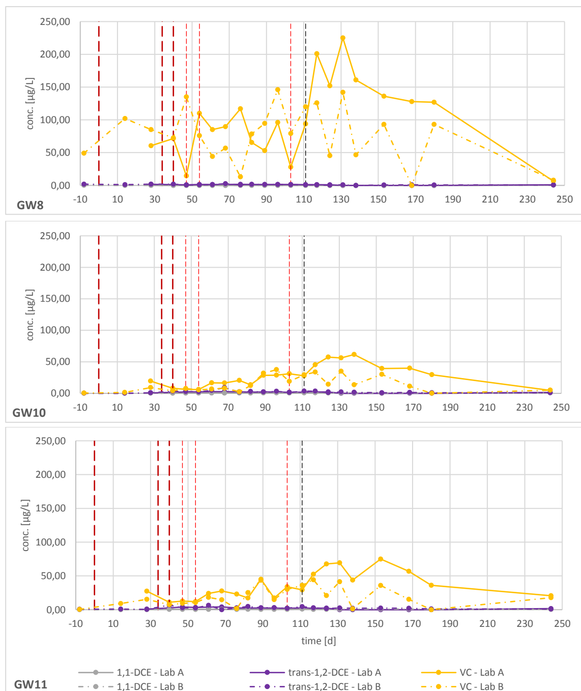
Abb. 38: Zeitlicher Verlauf der Konzentrationen von 1,1-DCE, trans -1,2 DCE und Vinylchlorid (VC) während des Feldversuches.
