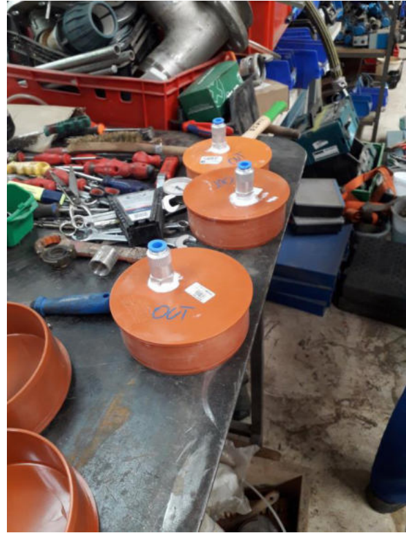
Bauteile für Inliner-Verpackung; Vorbereitung in der Werkstatt- Abdichtung der Ventile in den Deckeln
