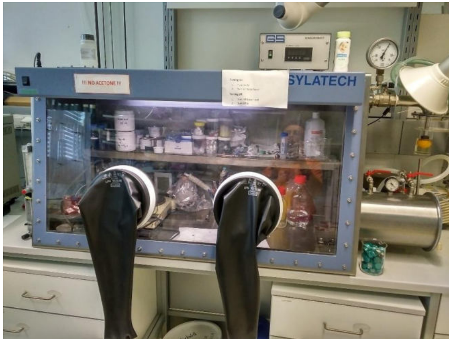
Abb 9: Glovebox zum Ansetzen der Batchversuche in Argonatmosphäre
