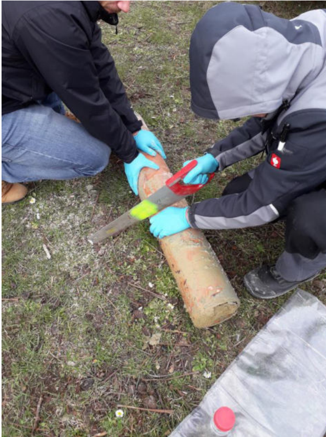
Zuschneiden Liner für Vakuumierung (Kunststoffsack: rechts im Bild)
