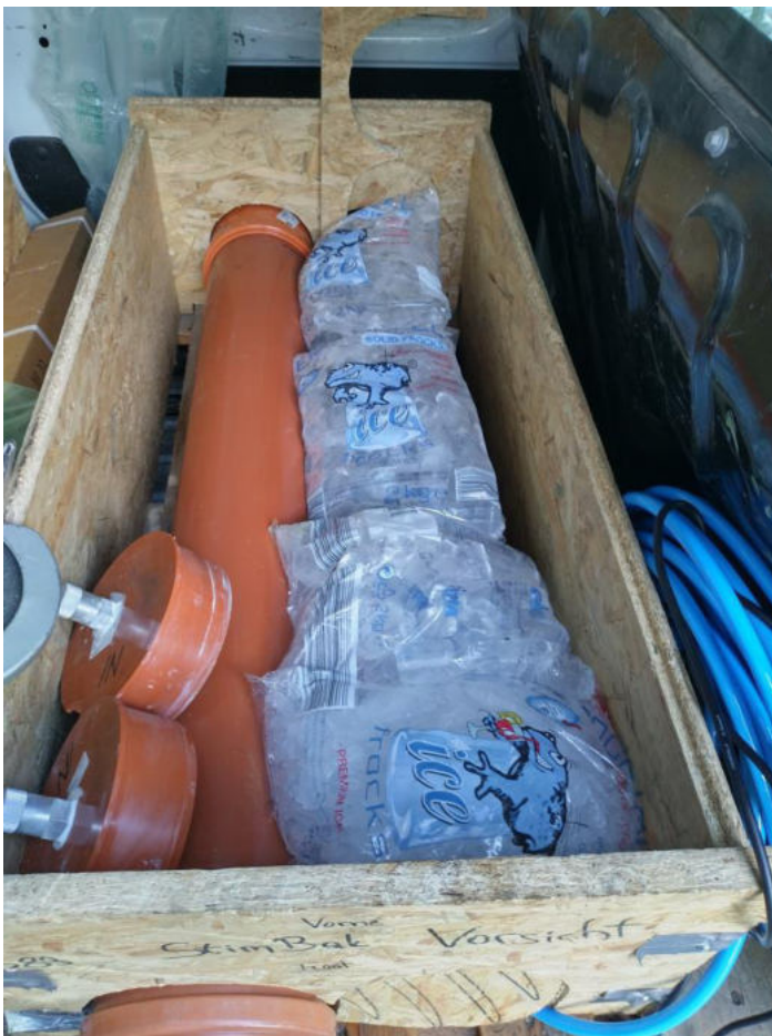
Gekühlter Proben transport (am Tag der Probenahme) ins Labor des AIT (hier: bei der Errichtung von GW9 nur 1 Inliner erbohrt)
